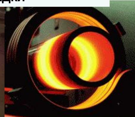
Тепловые посадки имеют ряд преимуществ по сравнению с соединениями, получаемыми на прессах. Они имеют большую прочность. Применение нагрева или охлаждения при посадке деталей позволяет во многих случаях обходиться без мощного прессового оборудования.
