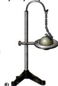
Рис. 18. Тепловое расширение металлического шара
