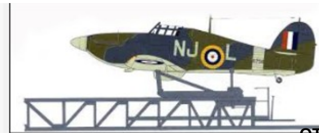
Установка Sea Hurricane Mk IA на подвижной рампе.
