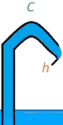
Жидкость поднимается по тонкому каналу в материале — капилляру, если этот материал обладает хорошей смачиваемостью
