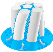
Нить, скрученная из волокон, имеет большое количество капиллярных каналов, которые втягивают в себя жидкость капиллярно
