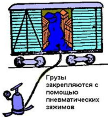
Грузы закрепляются с помощью пневматических зажимов
