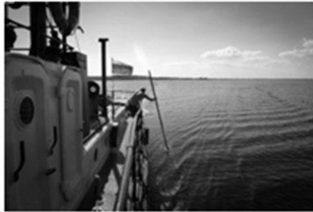
Измерение глубины в ручную шестом или веревкой
