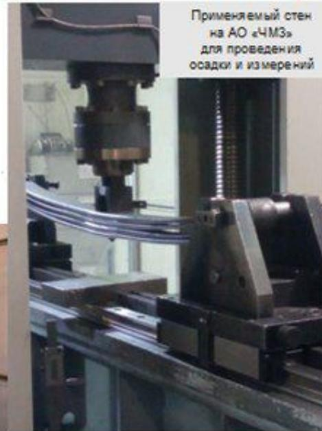
Применяемый стен на АО «ЧМЗ» для проведения осадки и измерений
