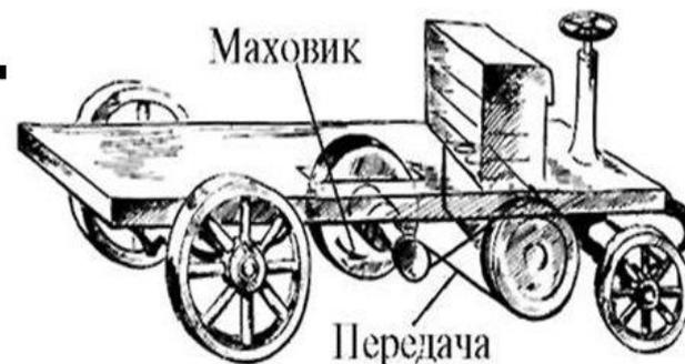
Для того , чтобы механизм преодолевал нагрузку и без резких рывком, маховик необходимо раскрутить и далее он по инерции вращается.
