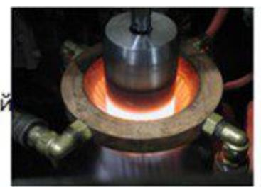
Деталь КОТОРУЮ одевают на другую деталь – предварительно НАГРЕТЬ
