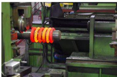
Видео именно по этой технологии не нашлось, Но речь идёт об УПРОЧНЕНИИ стали ДО навивания Пружины. Изменении СТРУКТУРЫ решётки и внутренне Напряжение в материале пружины.
