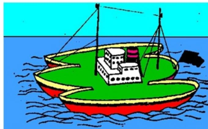
Трехкорпусное судно. Интерференция волн между корпусами уменьшает сопротивление воды движению судна
