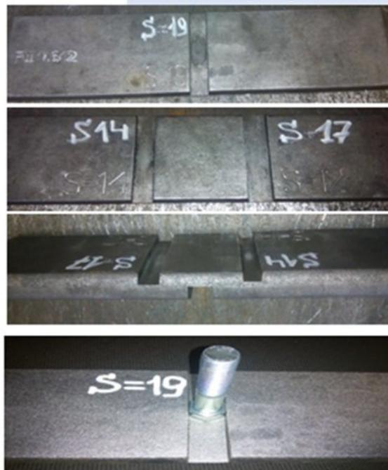
Дополнительно с в приспособлении изготовили пазы и для других размеров головок центрального болта: S=14, S=17, S=19.
