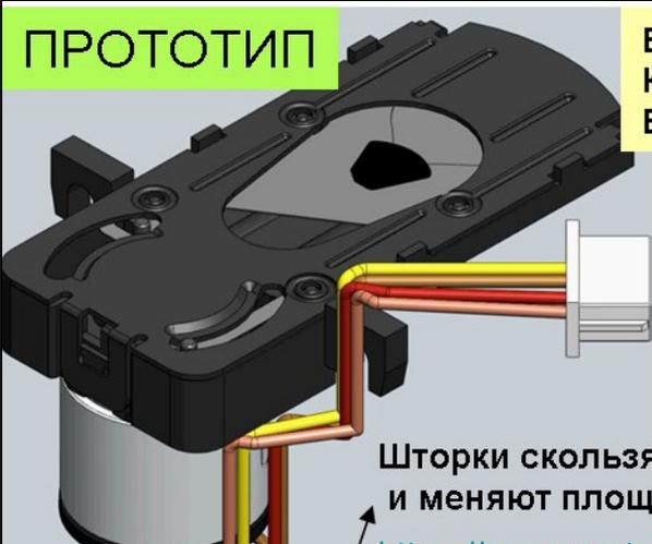
В прототипе – мотор, который приводит в движение 2 шторки
