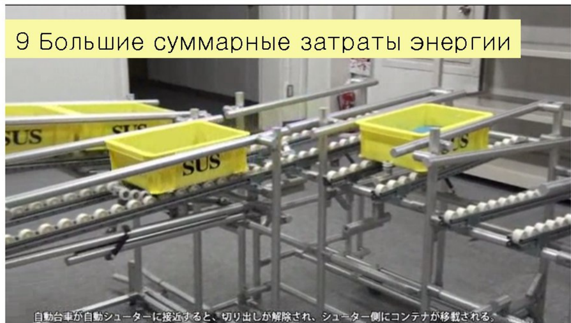
自動台車が自動シューターに接近すると、切り出しが解除され、シューター側にコンテナが移載される。
