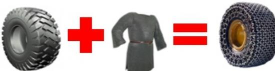
Для работы с твердыми острыми материалами, а также с материалами, имеющими высокую температуру, шины сверху защищают цепями, обеспечивающими защиту от острых краев породы, а также частично изолирующими их от воздействия высоких температур. На ВМЗ подобная защита применяется на колесах шлаковых погрузчиков ЛПК. В среднем применение защитных цепей позволяет увеличить ресурс шин в 3-5 раз. Для разных условий работы могут применяться соответствующие им типы защитных цепей.
