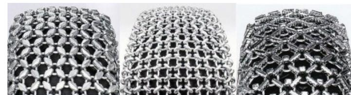
При погрузке обычных сыпучих материалов погрузчики оснащаются стандартными шинами. Но в процессе работы на крепких горных породах, погрузке горячих материалов (шлака) шины практически не выживают из-за частых порезов боковин и протектора острыми кусками отбитой породы, а также воздействия высоких температур.
